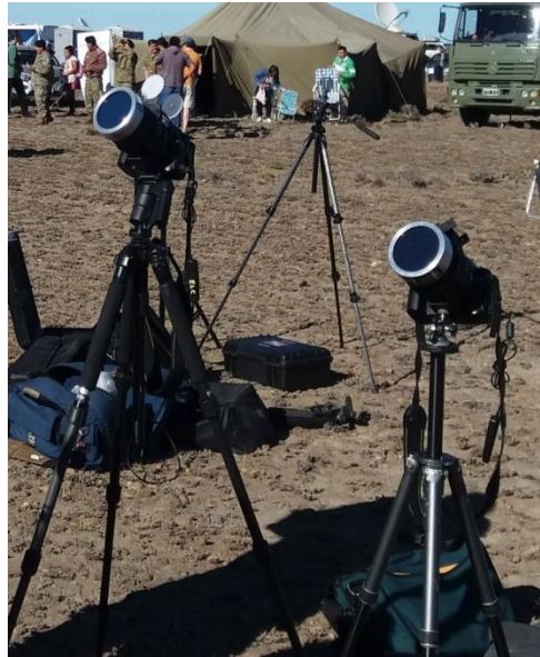
Figura 22. Izquierda, cámaras equipadas con filtros que se pueden adquirir en comercios especializados. Derecha, cámara equipada con un filtro de soldador, se cubrió el conjunto con un grueso plástico negro para evitar reflejos y facilitar la visión de la pantalla de la máquina. Las dos imágenes fueron obtenidas en oportunidad del eclipse anular de Sol del 26 de febrero de 2017 en Facundo, Chubut (C. Costa y S. Paolantonio).
