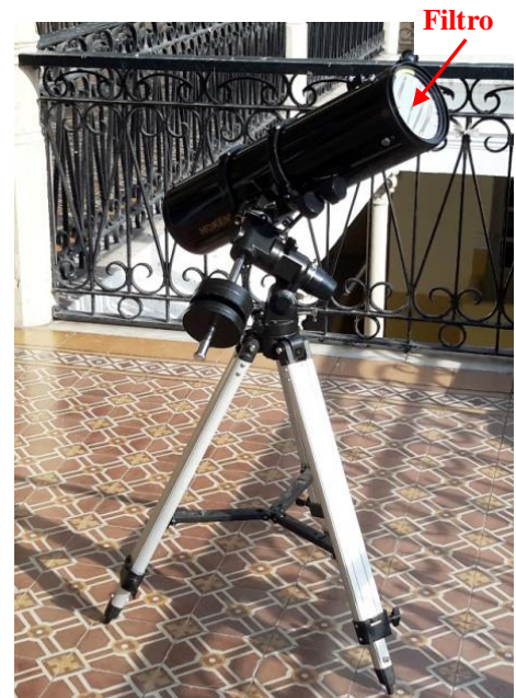
Figura 17. Telescopio reflector newtoniano dispuesto para la observación solar, con filtro de reflexión colocado a la entrada del tubo (S. Paolantonio).
