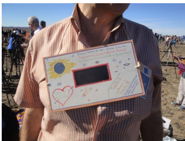
Figura 11. Izquierda, un filtro de soldadura DIN 14 montado en un cartón utilizado exitosamente en el eclipse de 1994. La fotografía se obtuvo en oportunidad del eclipse anular de Sol de 2017 observado desde Facundo, Chubut. Derecha, un filtro de soldadura cortado en dos partes y montado sobre cartón mediante cintas adhesivas para formar un anteojito (S. Paolantonio y M. Orellana).
