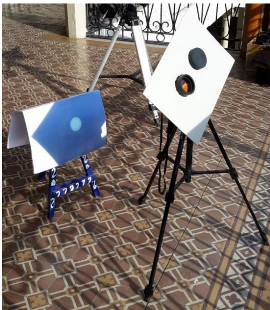
Figura 18. Prismático montado en un trípode dispuesto para proyectar la imagen del Sol, en oportunidad del tránsito de Mercurio del 9 de mayo de 2016. Uno de los objetivos está tapado y una hoja de cartón fue colocada al frente para proyectar la sombra necesaria para poder ver una imagen con buen contraste. El diámetro de la imagen del Sol para un instrumento dado, depende de la distancia a la que se coloca la pantalla, formada por una simple hoja blanca mate (S. Paolantonio).
