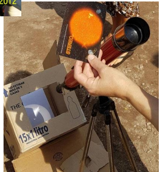
Figura 21. Una caja resultó de gran utilidad para resguardar de la luz la imagen proyectada por un pequeño telescopio, durante el eclipse del 26/2/2017 observado en Mar del Plata (C. Pérez Ferrer).
