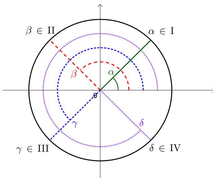
Para calcular el valor de las funciones trigonométricas en la circunferencia podemos asociarle un triángulo rectángulo a cada ángulo. Este triángulo se construye trazando un segmento paralelo al eje de la ordenadas desde el punto de intersección entre el lado del ángulo y la circunferencia, hasta el eje de las abscisas. A menos que se especifique lo contrario, estaremos trabajando con la circunferencia de radio 1 ( $r = 1$ ). Entonces:
