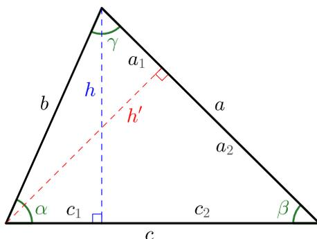
Si en el triángulo trazamos la altura  $h$  tomando al lado  $c$  como base podemos escribir que:
