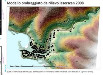
2008: rilievo laser effettuato dal Ministero dell'Ambiente con densità di 1 punto al mq.
