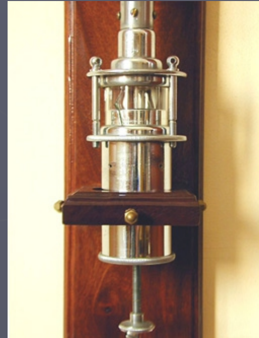
Detalle de la cubeta de un barómetro Fortín
